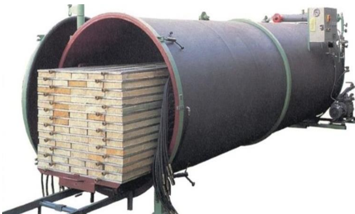
Рисунок 1.6 - Приклад вакуумної сушильної камери
