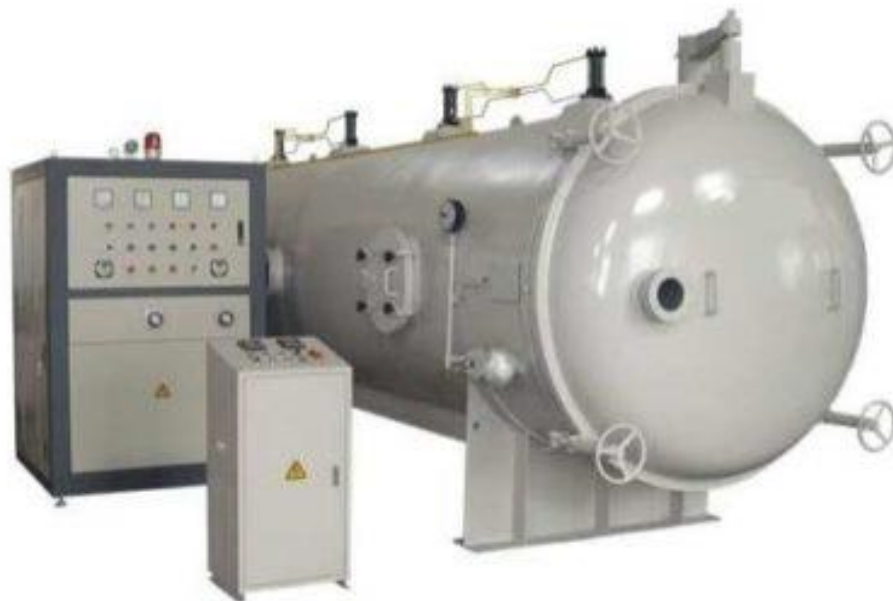
Рисунок 1.5 - Приклад НВЧ-сушильної камери
